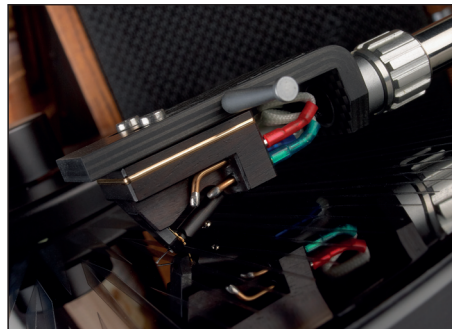
Das Gehäuse baut recht breit, dafür sind die Anschlusspins gut zu erreichen
